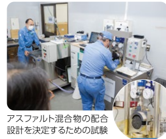
アスファルト混合物の重量を測定し密度を算出
