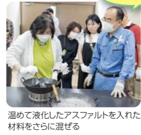
石粉、細砂、砕砂など5種類を鉄鍋に入れて温めながら混ぜ合わせる
