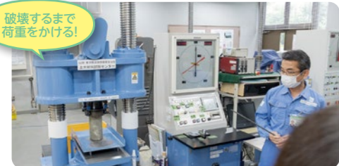
コンクリートの強度が定められた基準に達しているかを確認する試験
