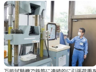
万能試験機で鉄筋に連続的に引張荷重を加える
